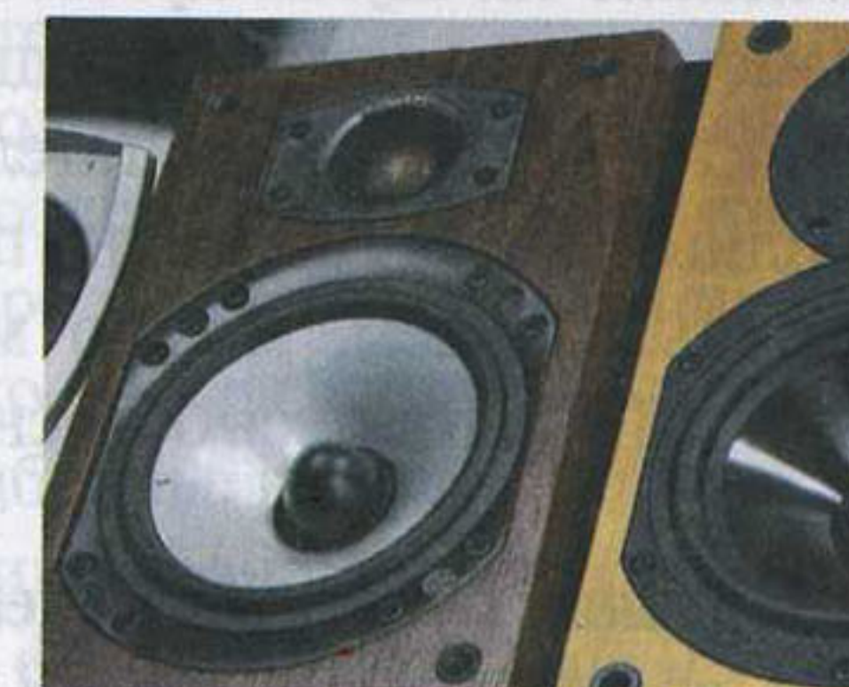
Рис. 10.3. Многополосные акустические системы
