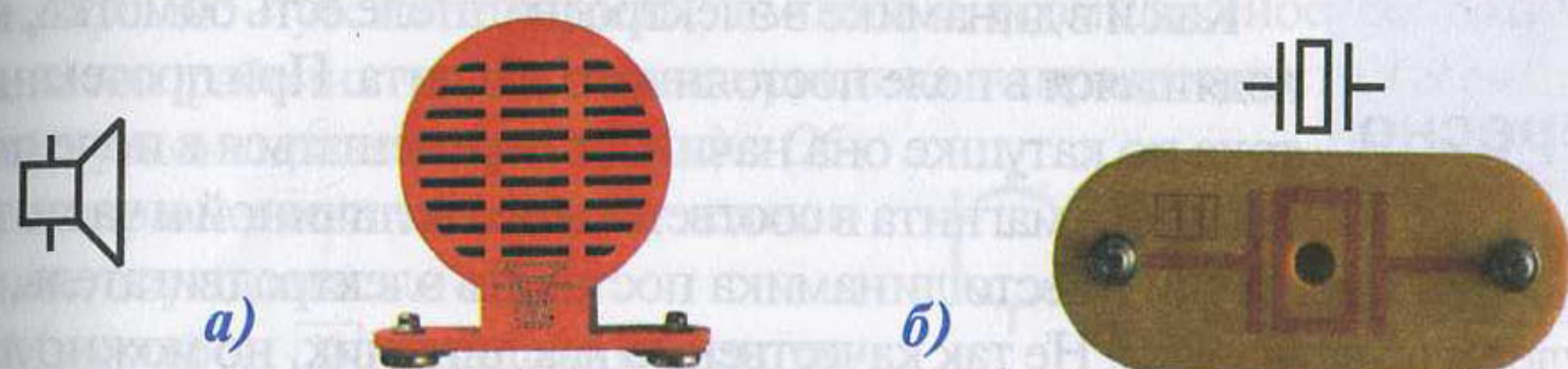
Рис. 10.1. Внешний вид и условные обозначения электродинамического (а) и пьезоэлектрического (б) излучателей
