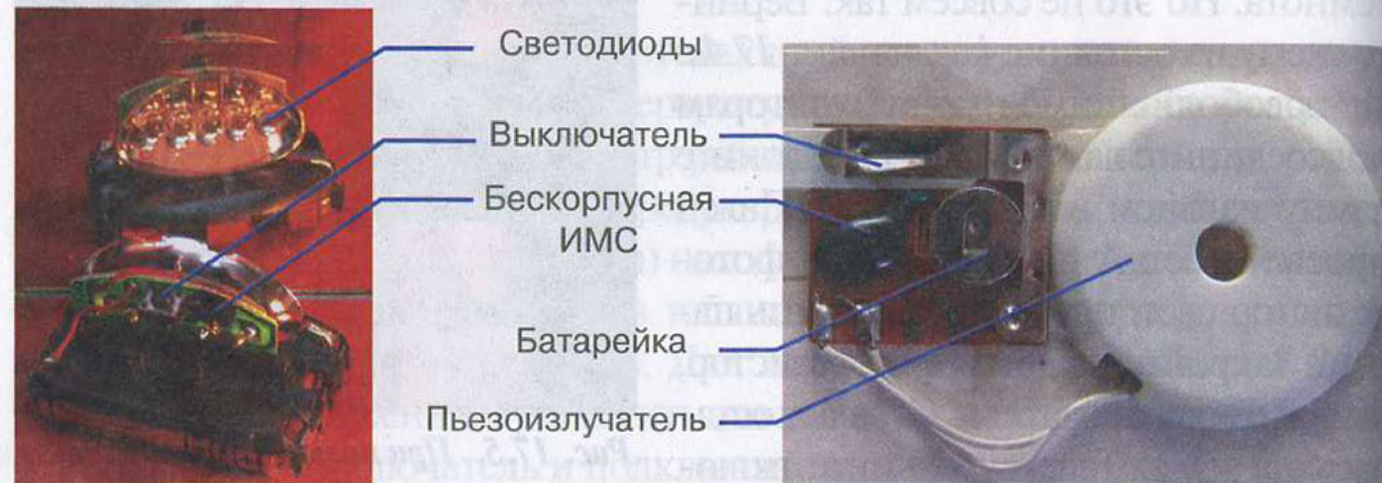
Рис. 18.2. Бескорпусные микросхемы в светодиодном фонарике (а) и в музыкальной открытке (б)
