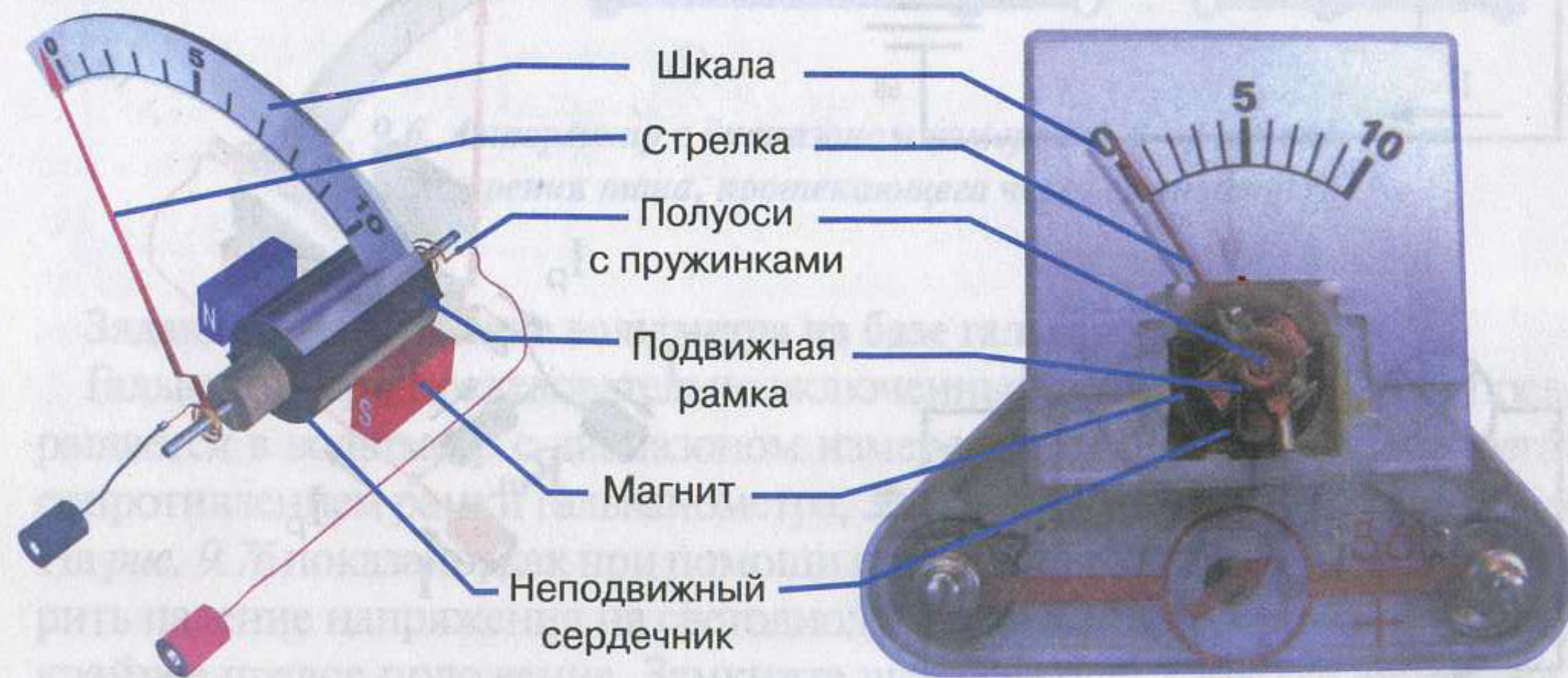
Рис. 9.2. Устройство и принцип действия гальванометра
