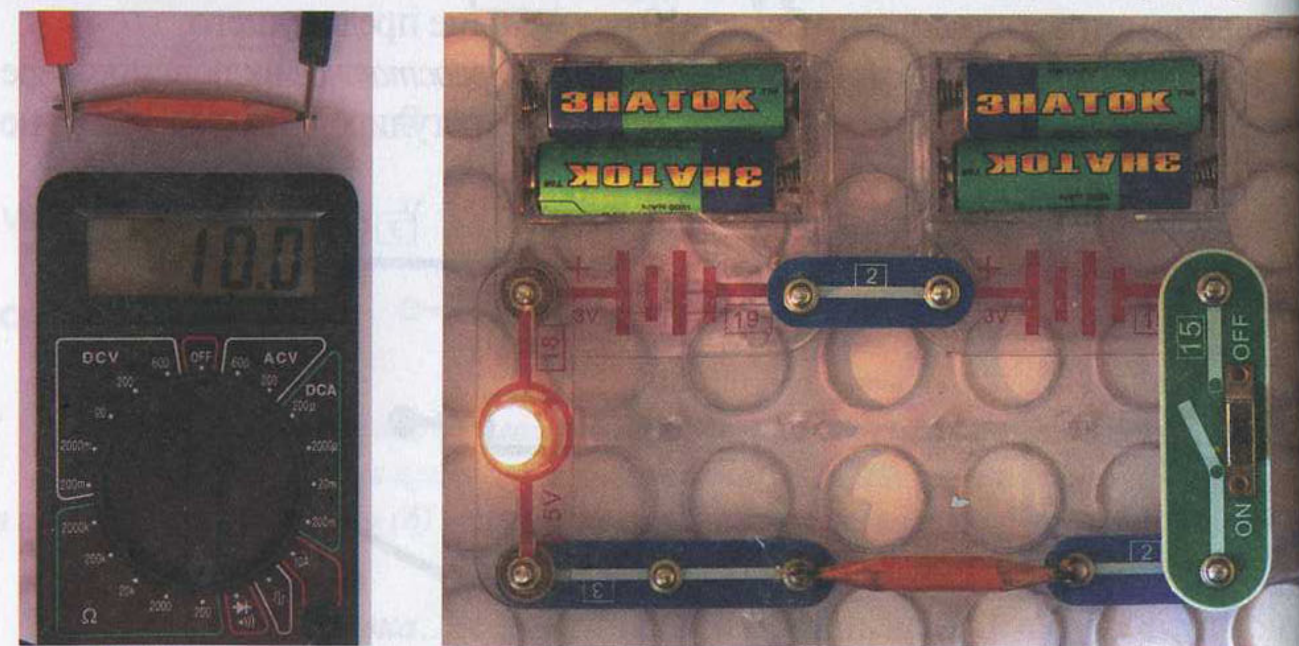
Рис. 5.7. Сопротивление гриффеля в простом карандаше больше, чем у металлов, но тоже мало — около 10 Ом (а). Его вполне можно использовать как резистор или проводник (б)
