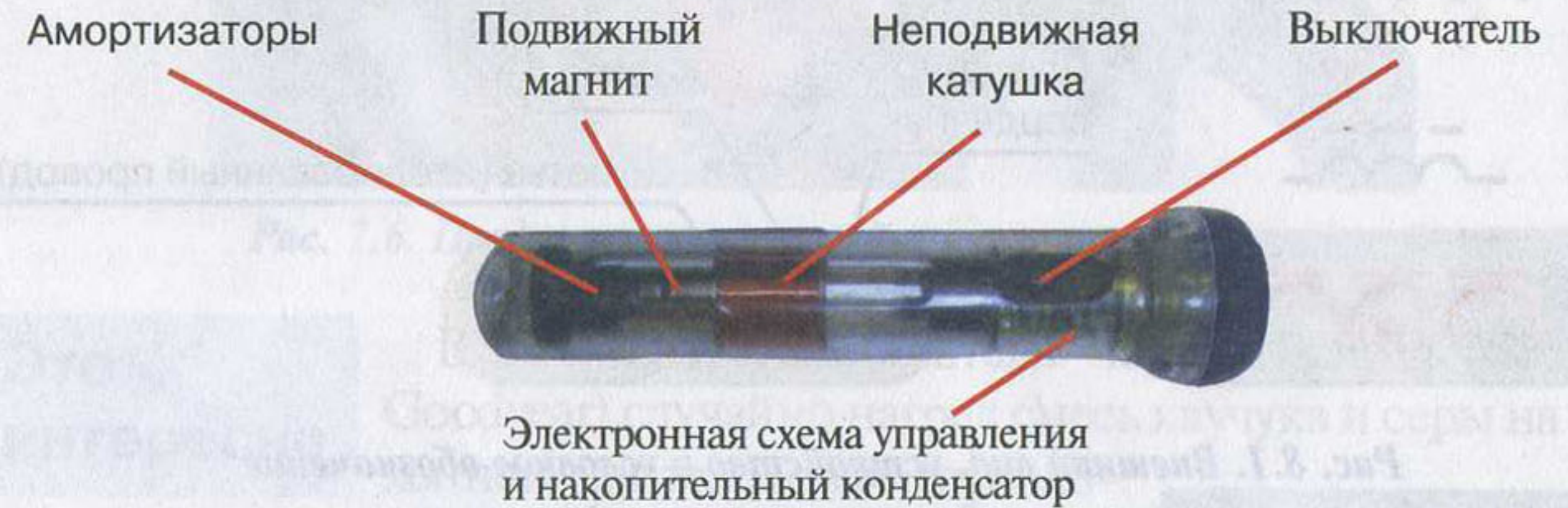
Рис. 8.5. Фонарь, работающий по принципу генератора Фарадея
