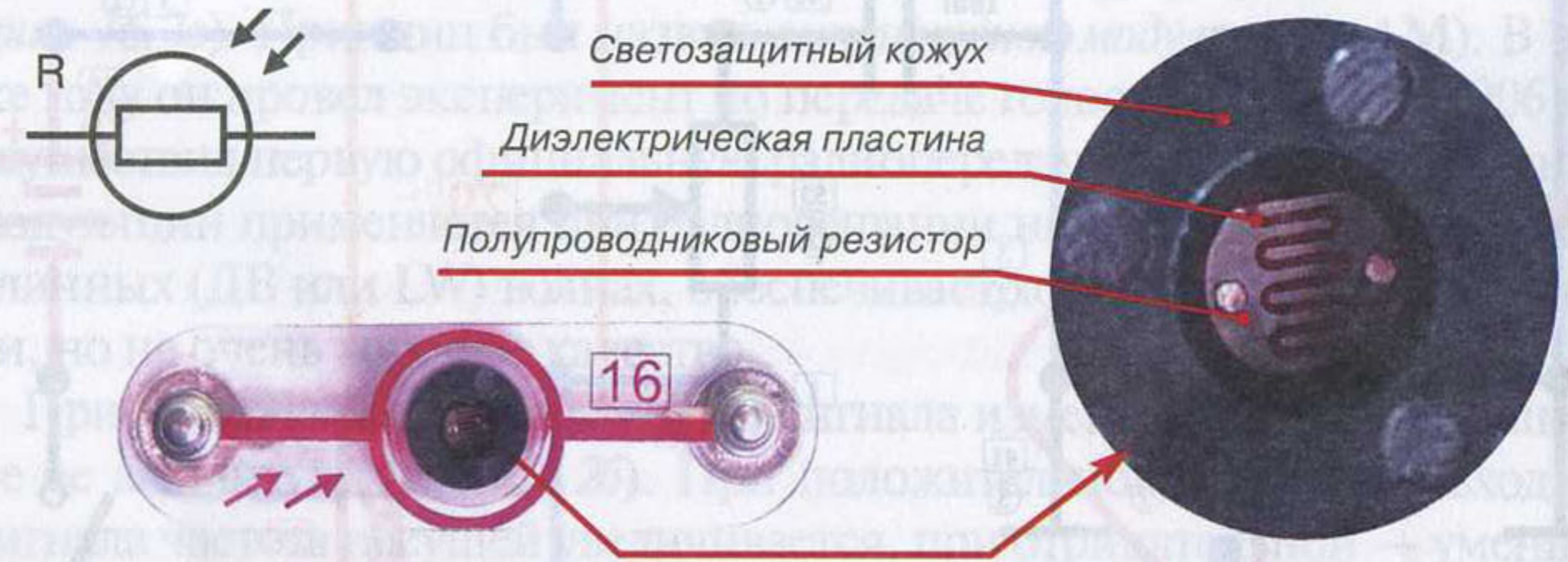
Рис. 17.2. Условное обозначение, внешний вид и устройство фоторезистора
