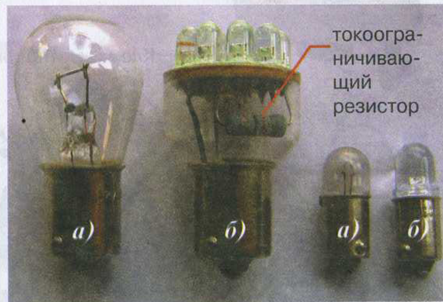
Рис. 3.10. Автомобильные лампы. Классические лампы накаливания (а) и их светодиодные заменители (б).
