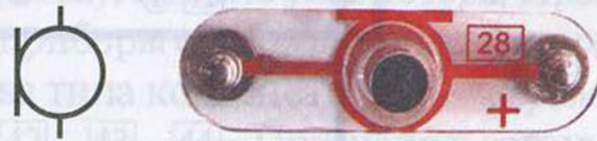
Рис. 11.1. Внешний вид и условное обозначения микрофона
