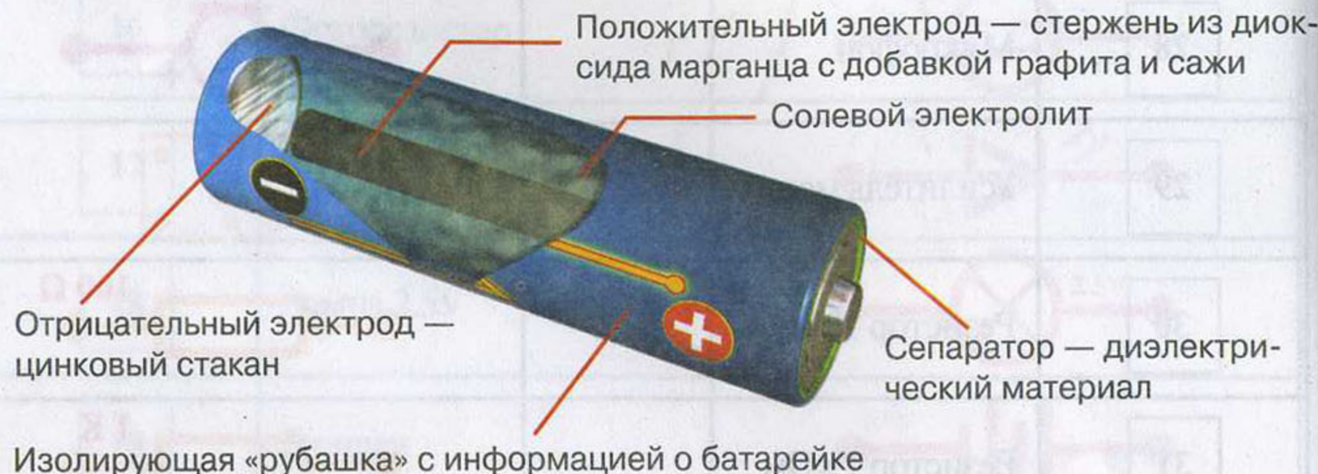
Рис. 1.2. Устройство простой солевой батарейки (элемента Лекланше). Щелочные (Alkaline) батарейки устроены по-другому (Разбирать их категорически запрещено — это опасно для здоровья!)
