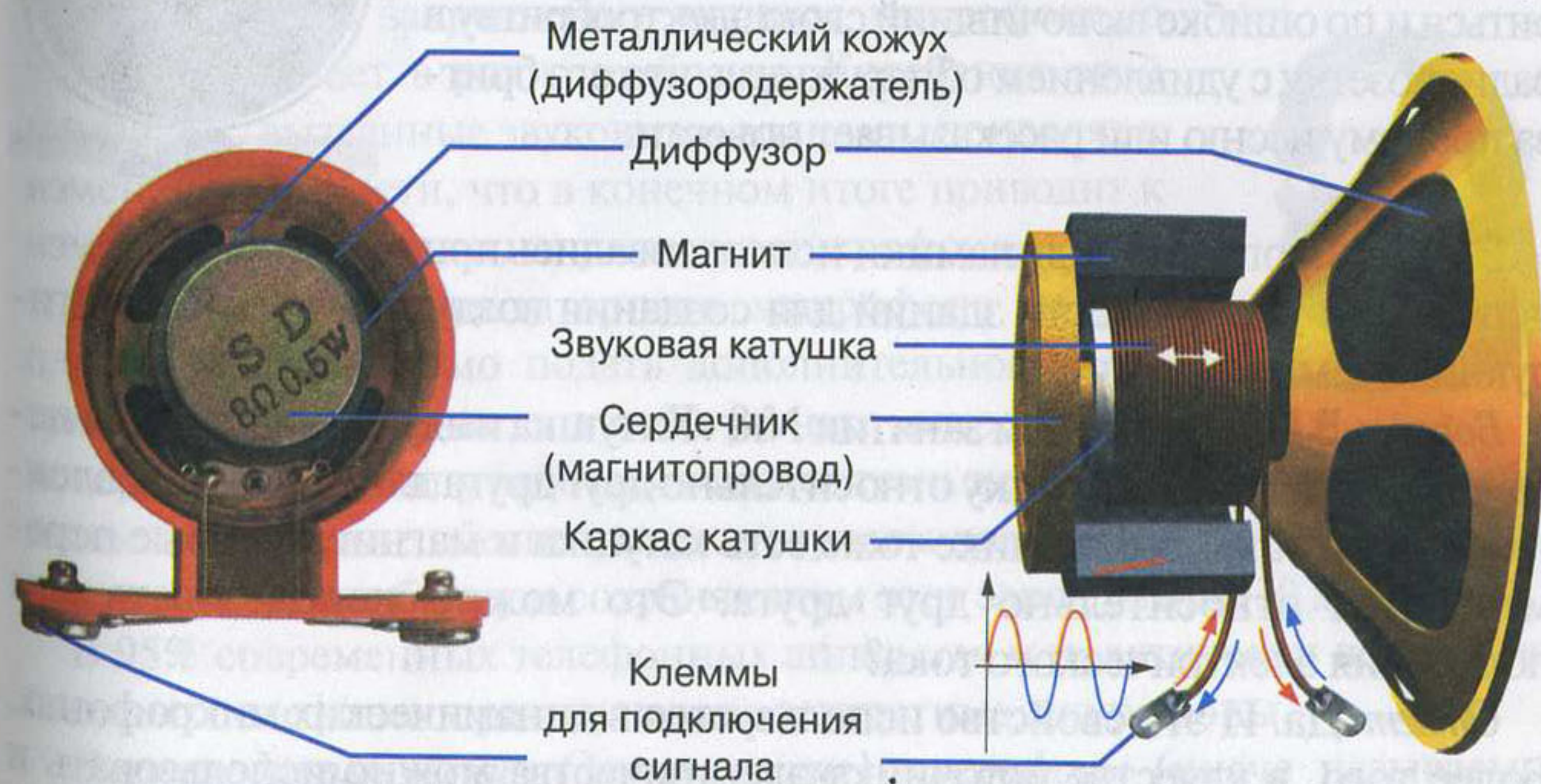
Рис. 10.2. Устройство электродинамического громкоговорителя (динамика)
