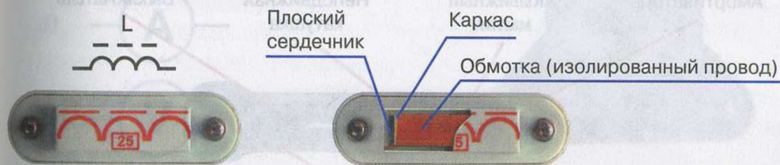
Рис. 8.1. Внешний вид, устройство и условное обозначение катушки индуктивности с сердечником
