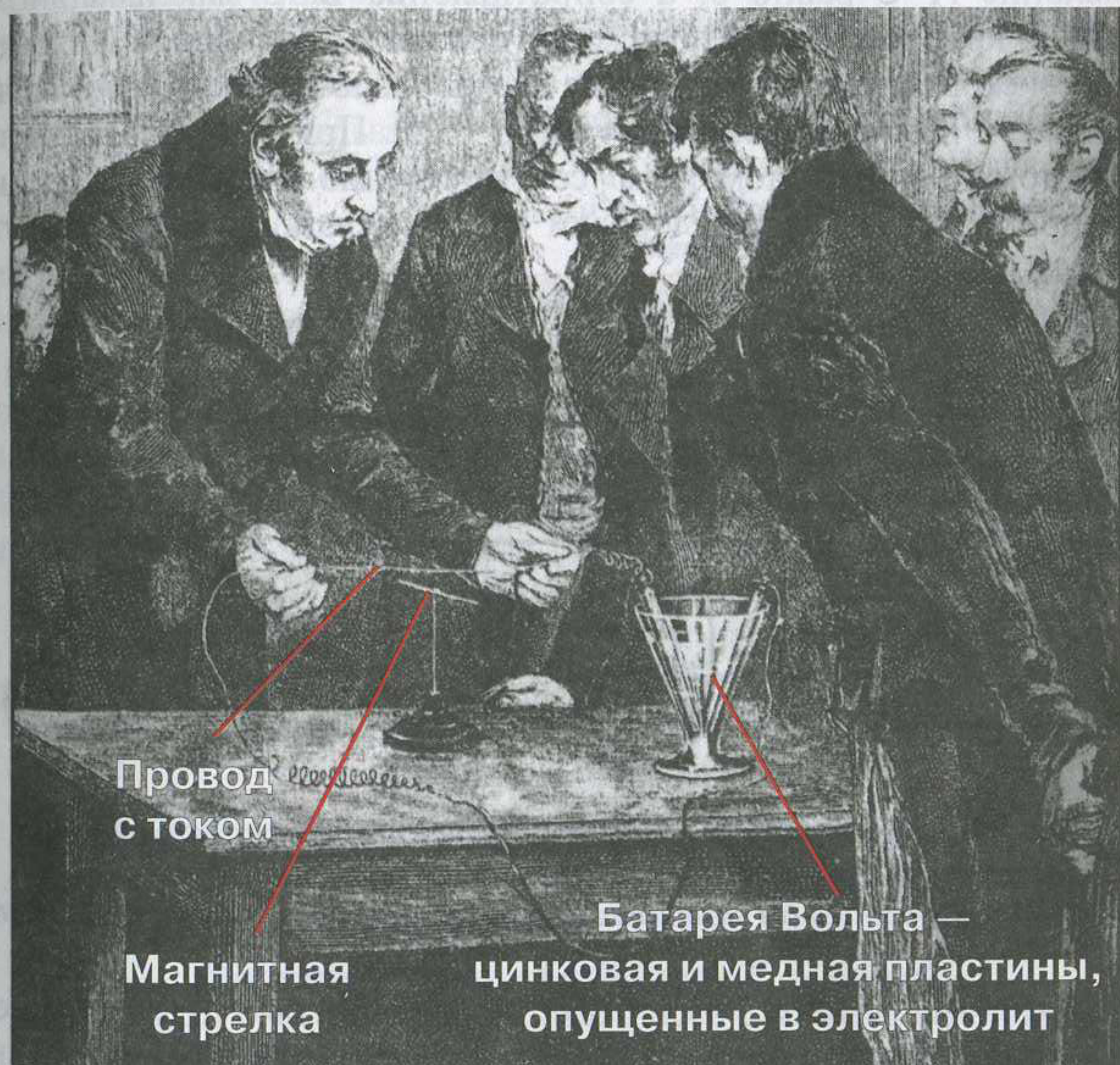
Эрстед демонстрирует своим коллегам взаимодействие проводника с током и магнитной стрелки
