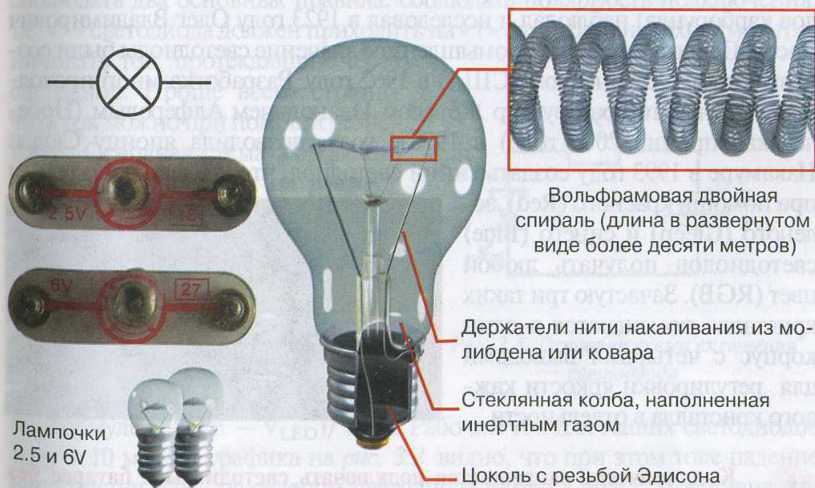
Рис. 3.1. Внешний вид, устройство и условное обозначение ламп накаливания
