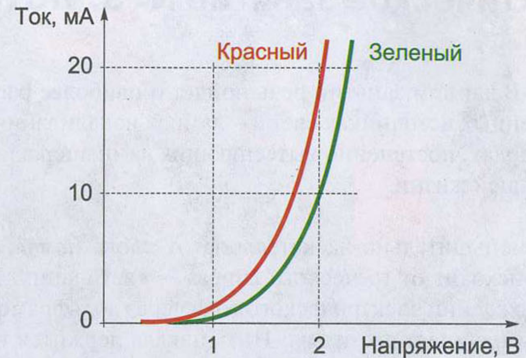
Рис. 3.3. Вольт-амперные характеристики светодиодов [17] и [26]
