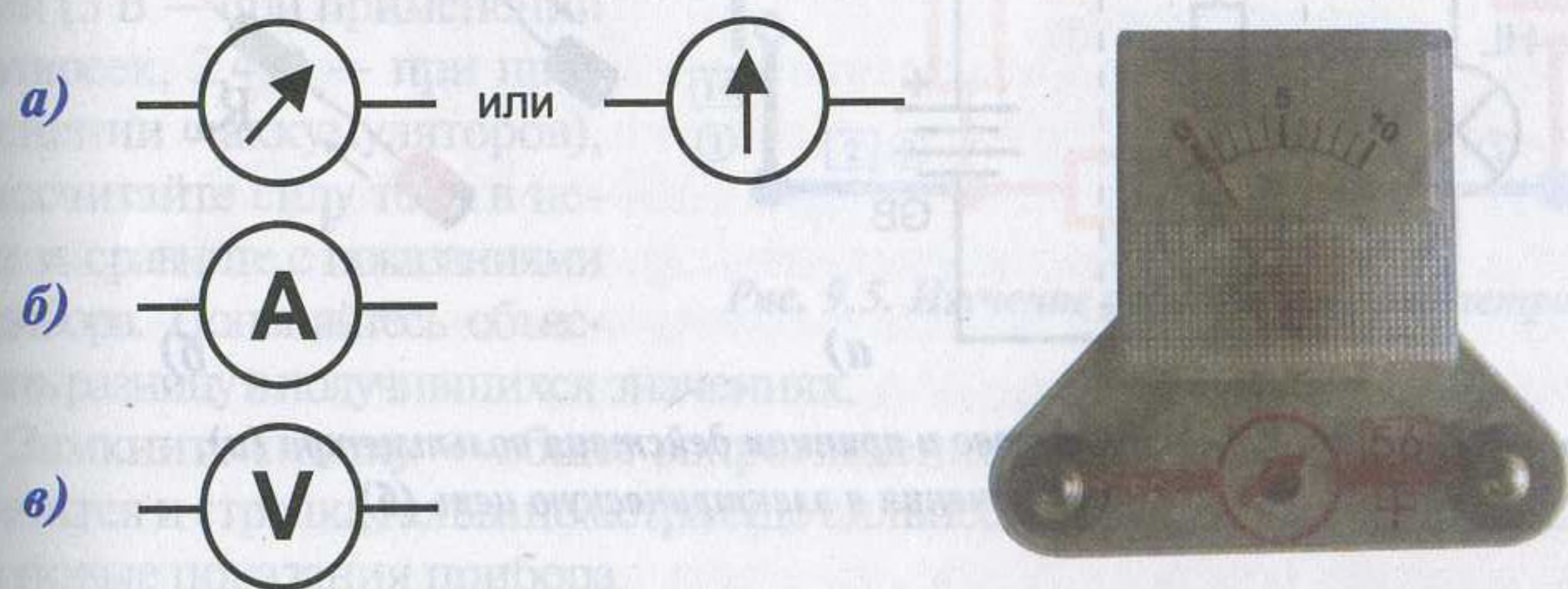
Рис. 9.1. Внешний вид гальванометра и условные обозначения гальванометра (а), амперметра (б) и вольтметра (в)
