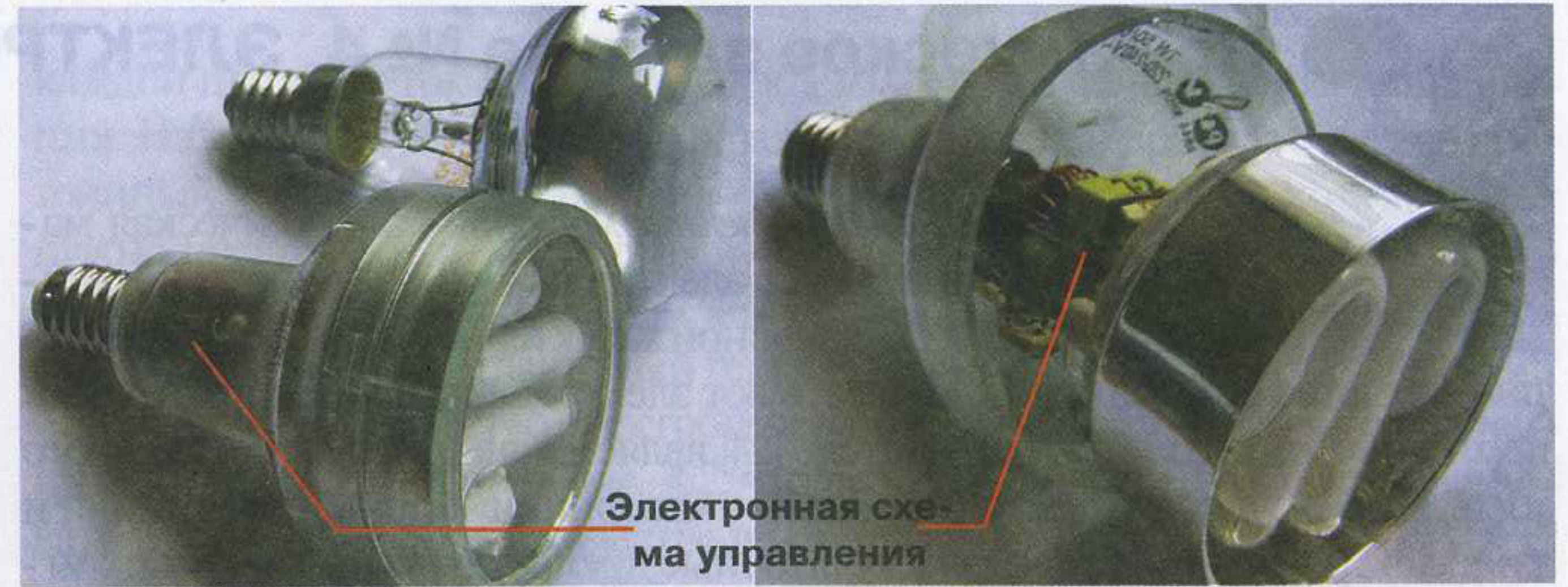
Рис. 3.11. Лампа накаливания и ее энергосберегающий аналог (а). Энергосберегающая лампа в разобранном виде (б)
