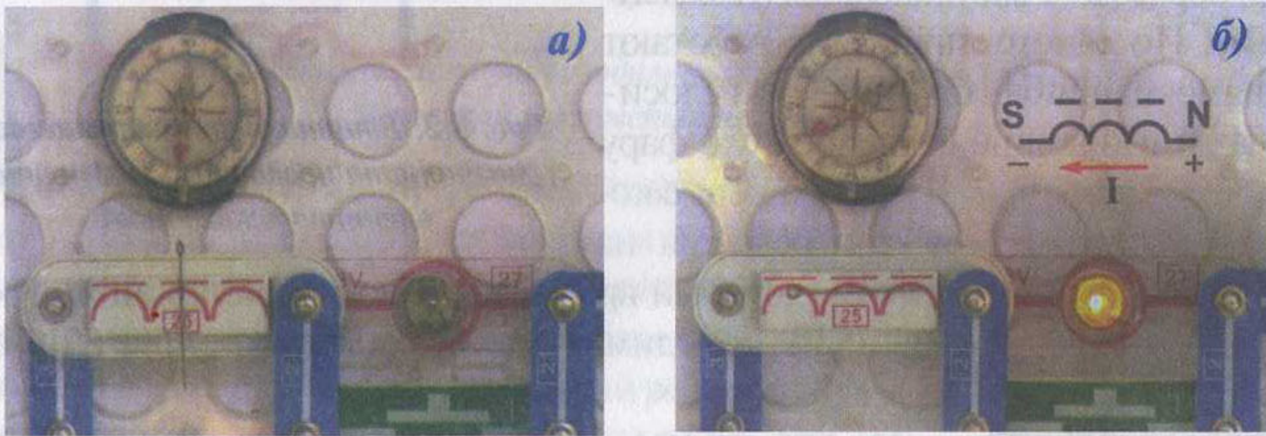
Рис. 8.4. Влияние проводника с током на магнитную стрелку и булавку
