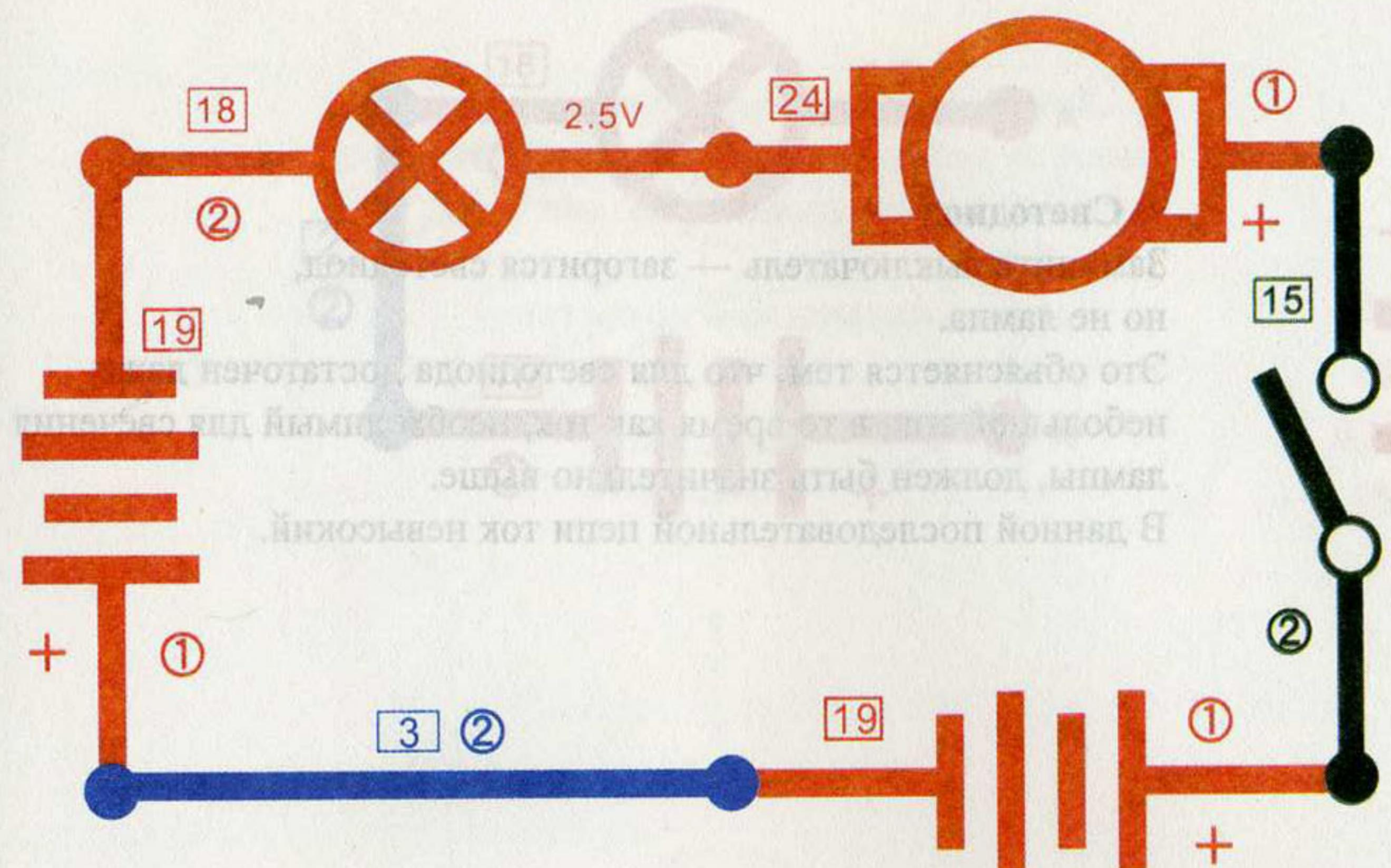
**5. Последовательное соединение лампы и вентилятора**
