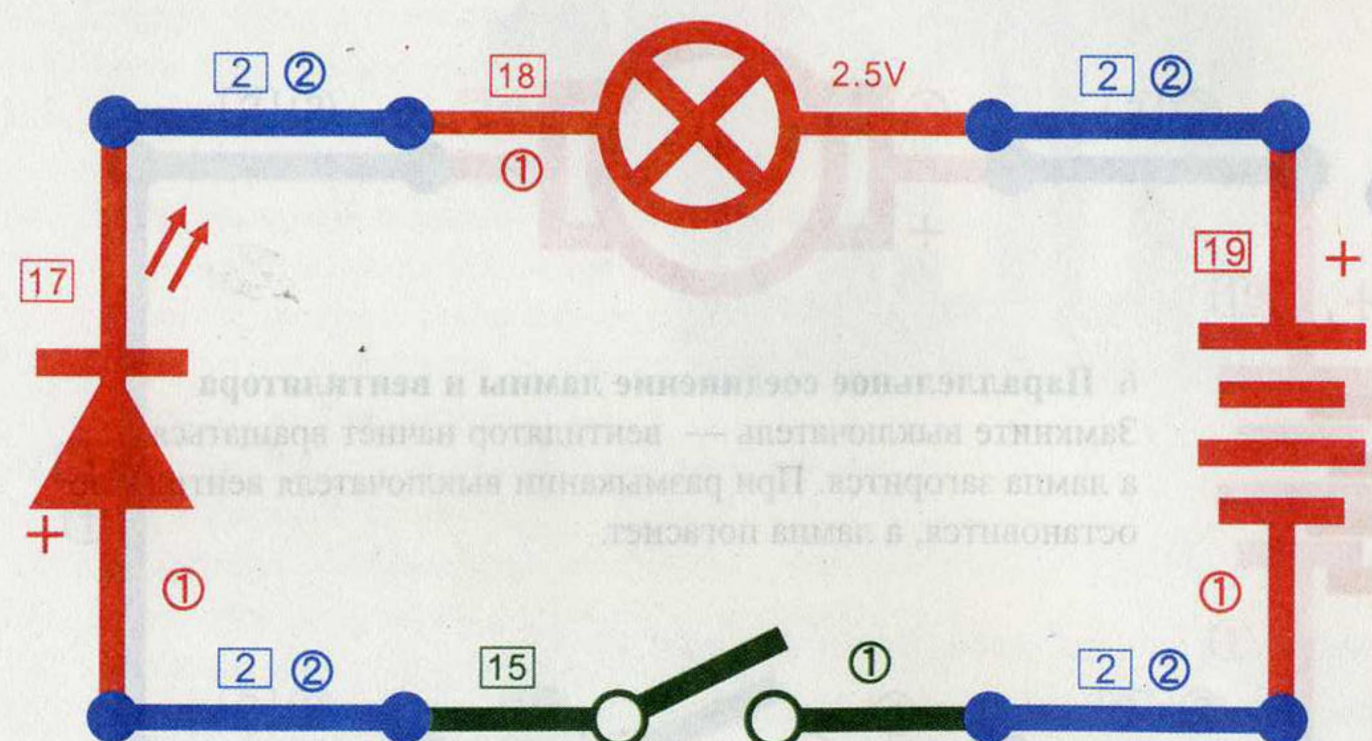
**8. Проверка проводимости светодиода**
