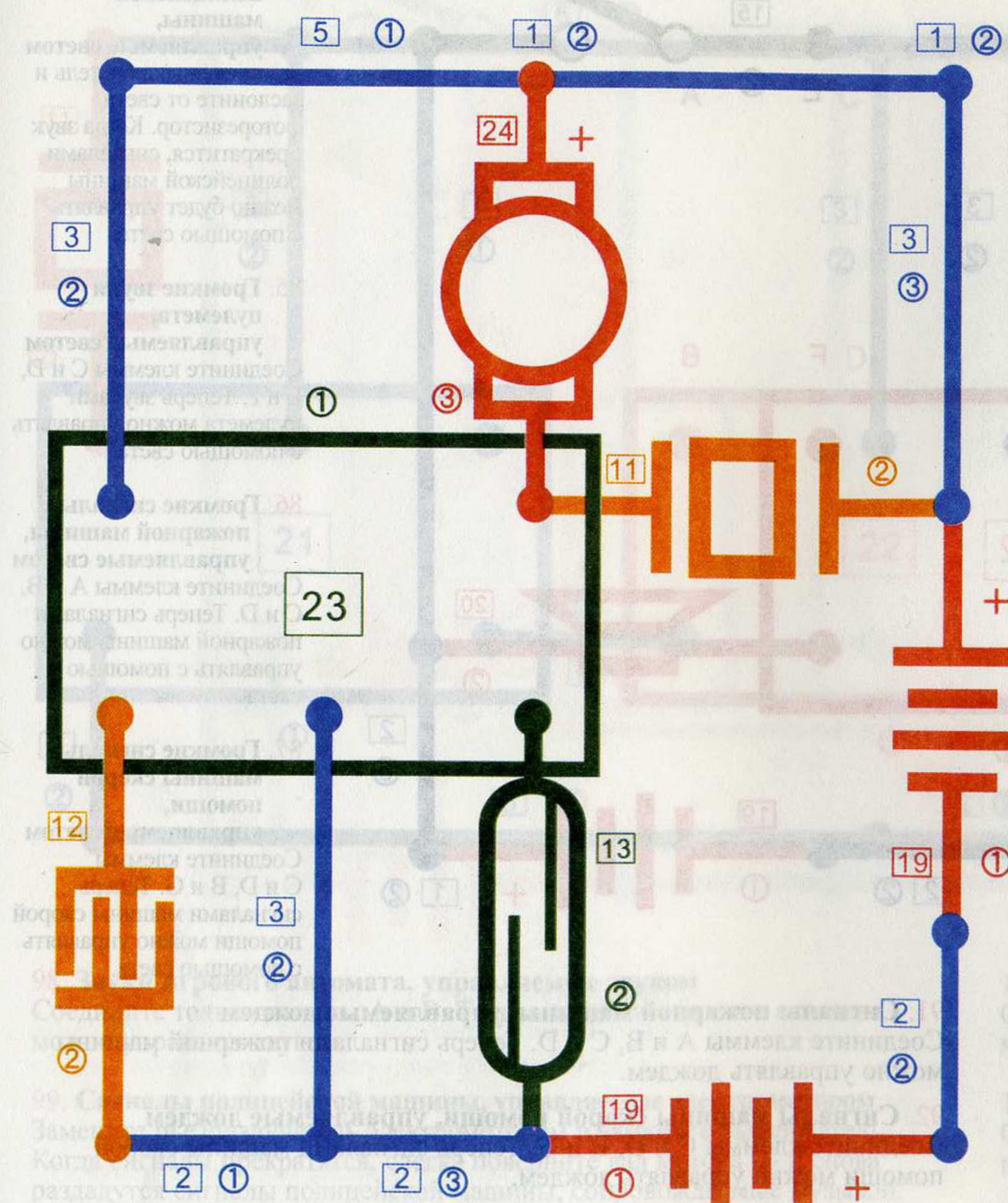
**81. Вентилятор со звуком, управляемый магнитом**
