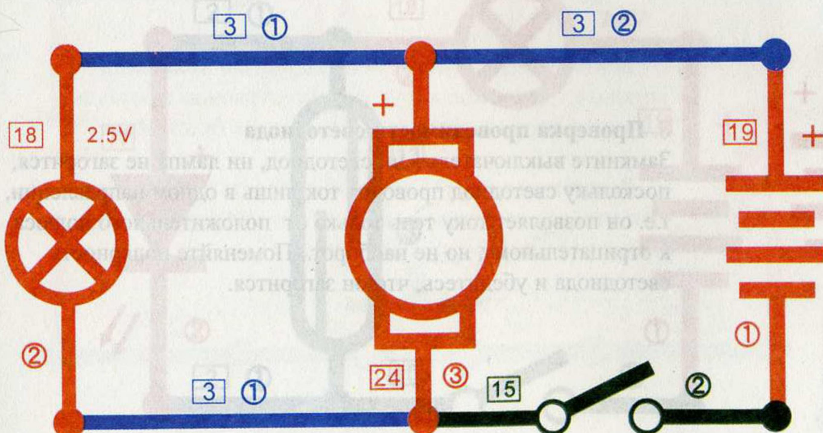
**6. Параллельное соединение лампы и вентилятора**
